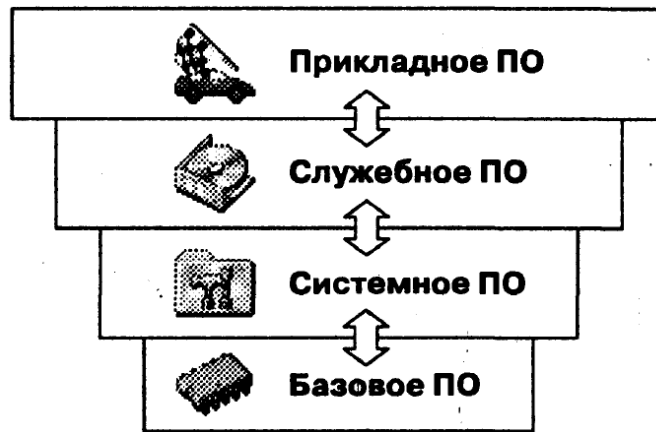
Рисунок 28.1 – Разделение программного обеспечения (ПО) вычислительного устройства на уровни
